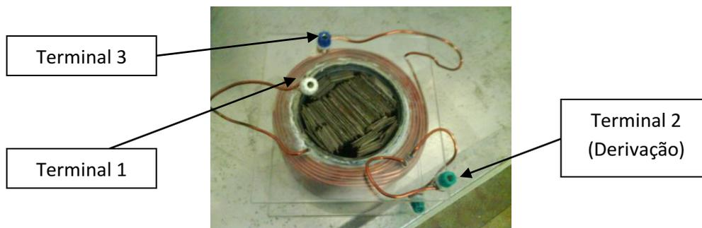
**Figura 13: Representação dos terminais do Indutor**
