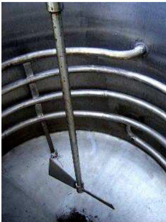
Figura 4 – Visualização interna de um tanque com serpentina e agitador (ABOISSA, 2008)
