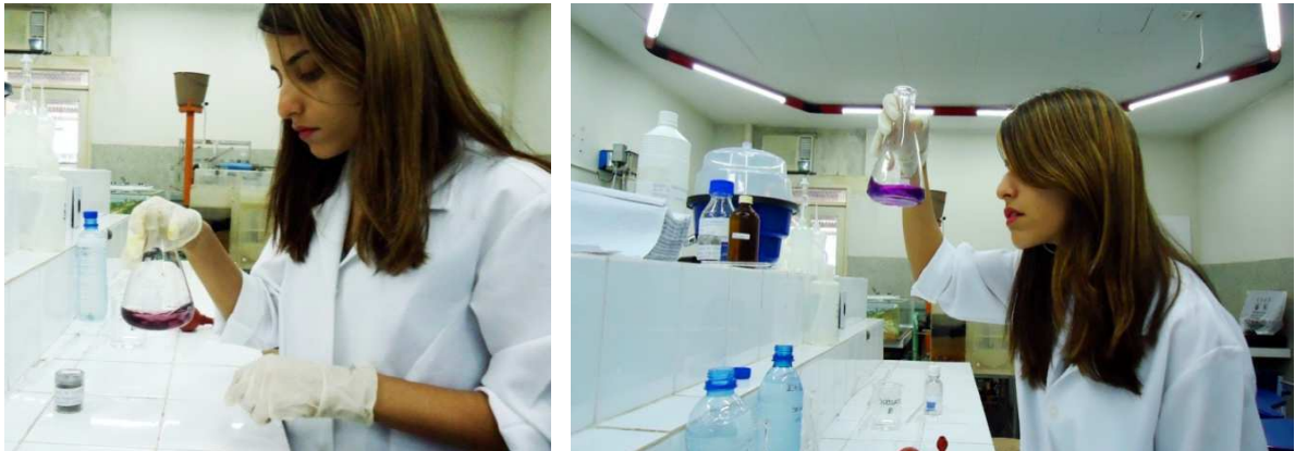
Figura 8 - Determinação da dureza do cálcio e do magnésio das amostras
