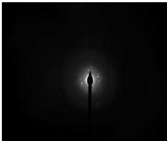
Figura 33: Padrão de difração de elétrons do suporte HBC
