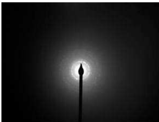
Figura 36 (a): Padrão de difração de elétrons da região policristalina
