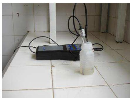
**Figura 5** - Análise de condutividade elétrica dos efluentes coletados durante os ensaios
