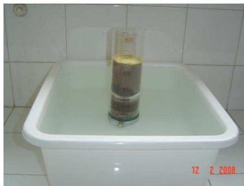
**Figura 3** - Coluna em recipiente de plástico contendo água destilada
