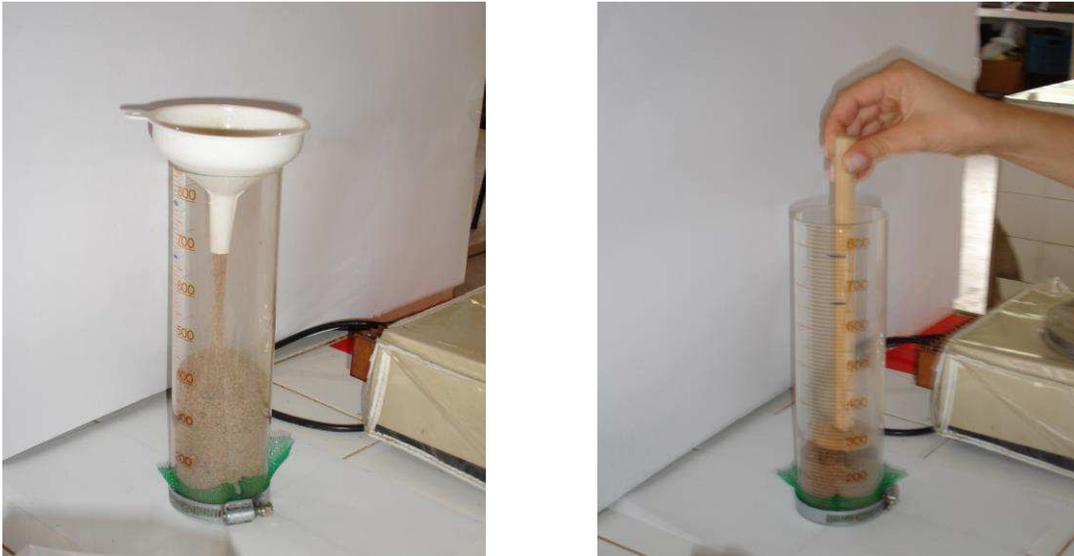
**Figura 2** - Montagem das colunas de lixiviação
