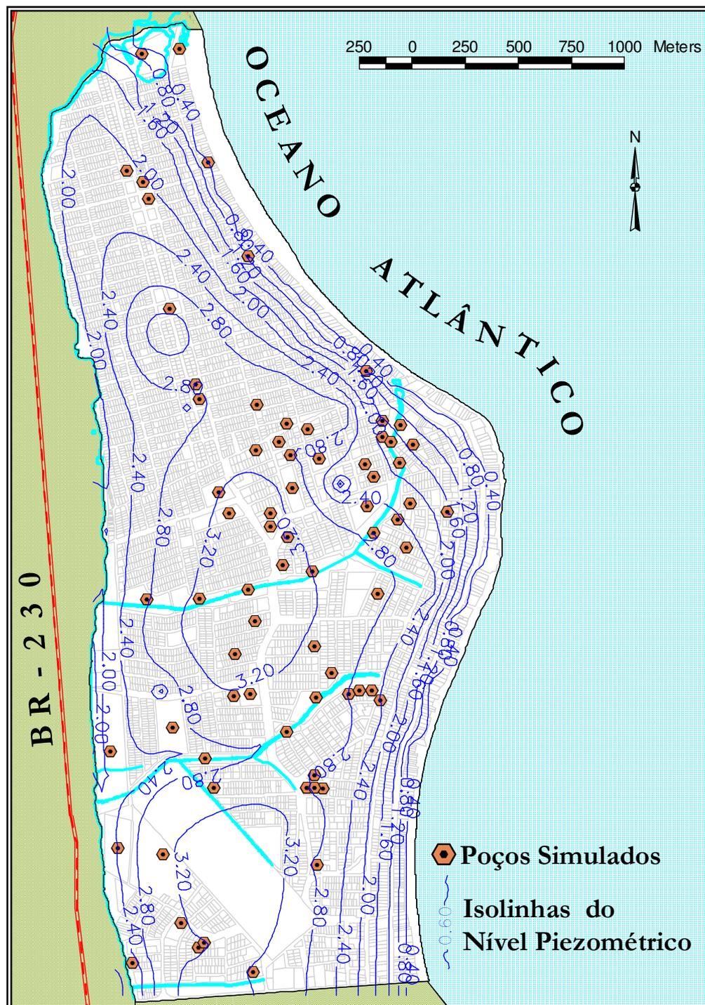
Figura 80 – Níveis piezométricos limite após rebaixamento (15/06/99 a 15/07/99).
