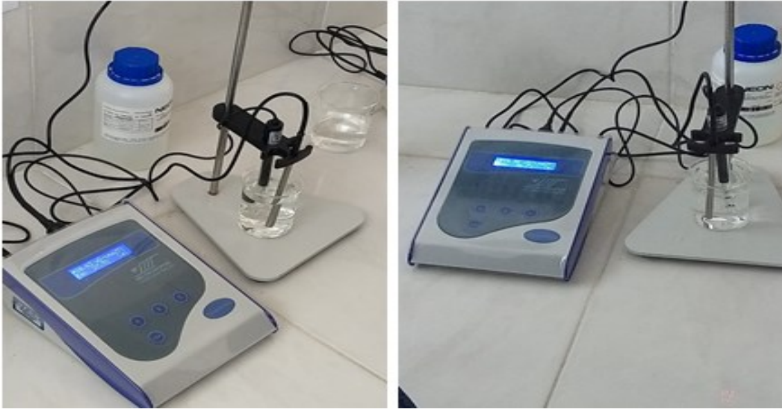
Fotografia 4 - Verificação da condutividade elétrica utilizando um condutivímetro.
