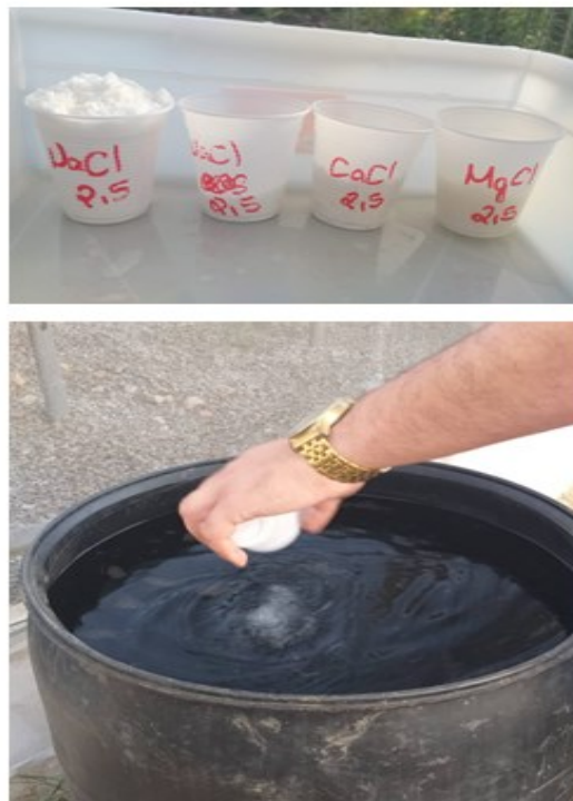
Fotografia 5 - Separação, mistura e armazenamento de NaCl em diferentes concentrações em água de abastecimento.
