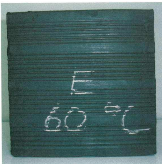
Figura 4.36 - Vista da amostra antes de ser submetida a secagem ( t = 0 ) à temperatura constante de 60^{\circ}\text{C} . a) Frontal, b) Traseira, c) Esquerda e d) Direita.
