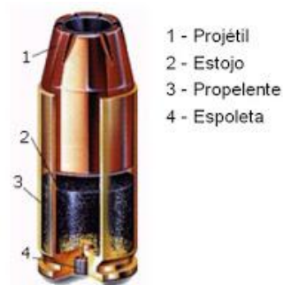
Figura 1 – Cartucho: componentes principais
