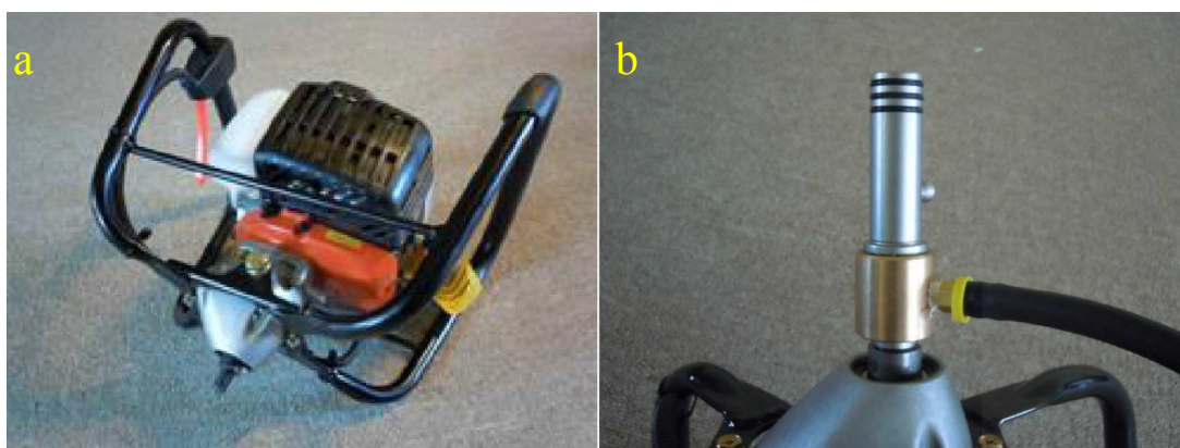
Figura 8 a) Plugadeira manual Tanaka, modelo 270 PDFH e b) Detalhe mostrando o local de encaixe da haste que contém a coroa diamantada.
