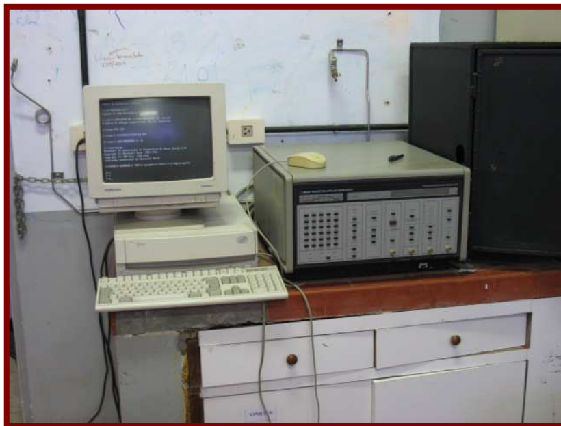
Figura III-8 - Potenciostato utilizado nas análises de cronoamperometria.
