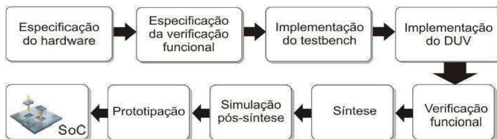
Figura 1 - Fases do processo de desenvolvimento de hardware na ordem proposta por VeriSC (SILVA, 2007).
