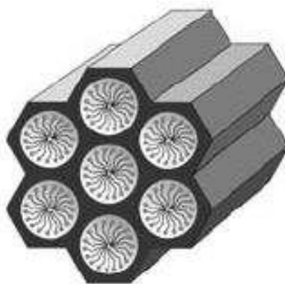
FIGURA 3 – Perfil estrutural da MCM-41
