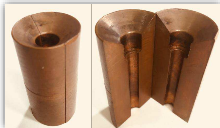
Figura 21 - Molde para injeção dos botões das ligas CuAlNi e CuAlNi(MnTi).
