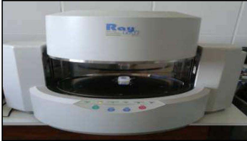
**Figura 3.6** - Espectrômetro de dispersão de raios X, modelo EDX-720
