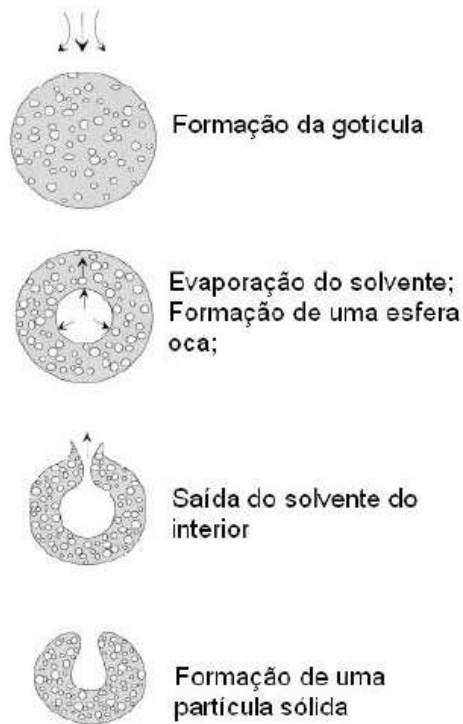
Figura 2.6 - Formação de partícula por secagem por aspersão (CAO et al., 2000)
