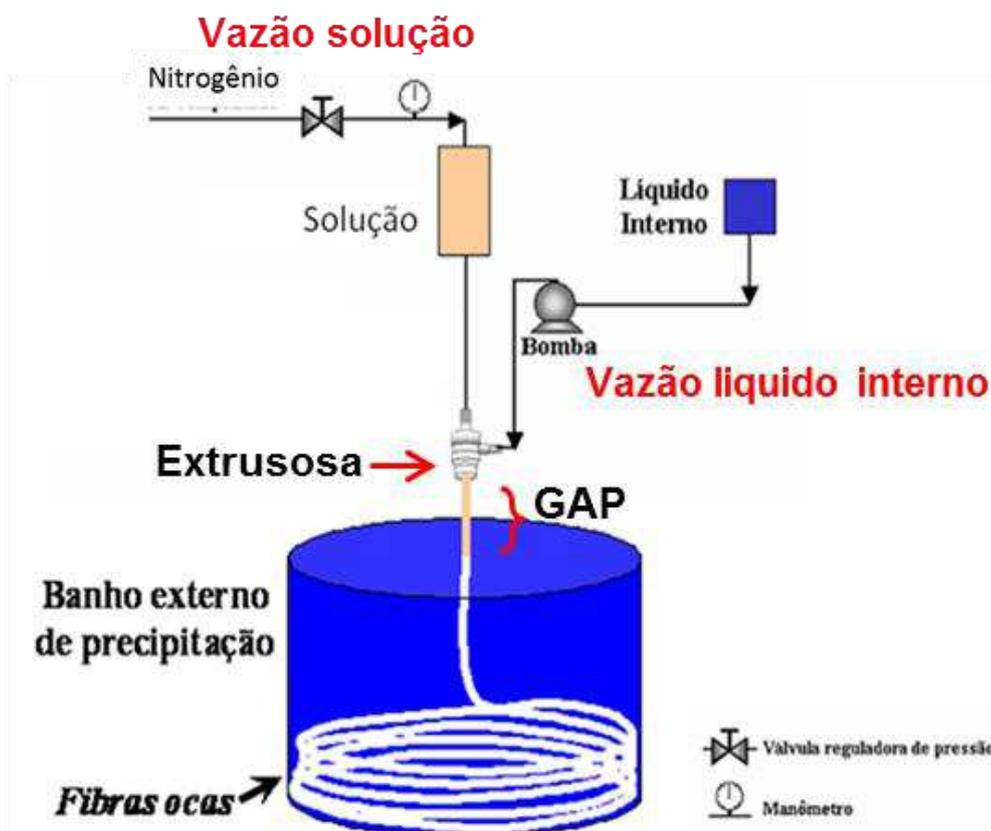
Figura 32 - Representação esquemática do processo de obtenção das membranas de fibra oca. (Habert et al., 2006)
