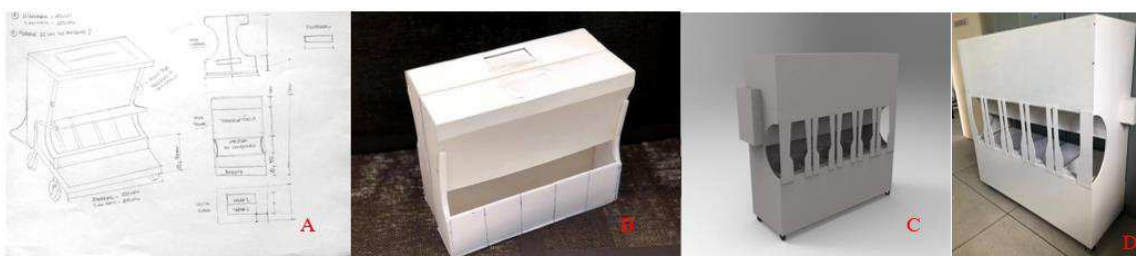
Figura 63: Concepção do produto final (a) Croqui, (b) Mockup , (c) 3D e (d) Protótipo.
