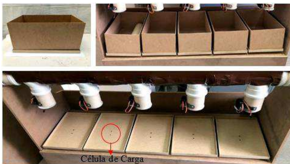
Figura 28: Base de sustentação e posicionamento das células de carga.
