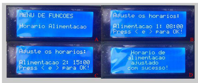
Figura 79: Horário da alimentação animal (a) Menu inicial para o ajuste do horário de fornecimento do suplemento, (b) Alterar o primeiro horário, (c) Alterar o segundo horário e (d) Conclusão do ajuste.
