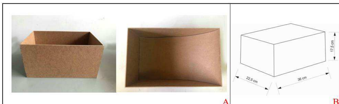
Figura 27: Cocho individualizado para cada animal (a) Estrutura em MDF e (b) Dimensionamento.
