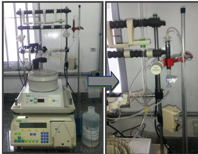
Figura 17 - Sistema experimental para adsorção em coluna de leito fixo.
