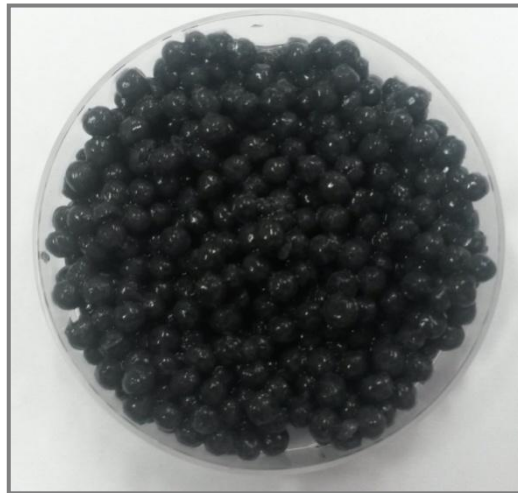
Figura 12 – Esferas de carvão ativado da torta de mamona imobilizada em quitosana.
