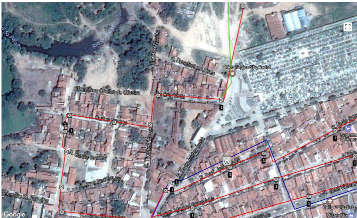
Figura 26 - Imagem de Satélite da Rede de Fibra Óptica do bairro Guanabara, Sousa-PB
