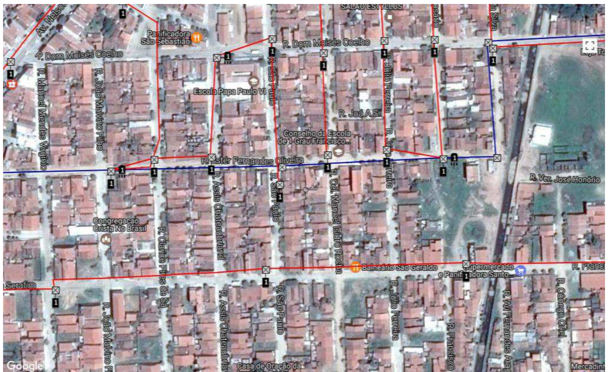
Figura 38 - Imagem de Satélite da Rede de Fibra Óptica do bairro J. Sorrilandia I Sousa-PB
