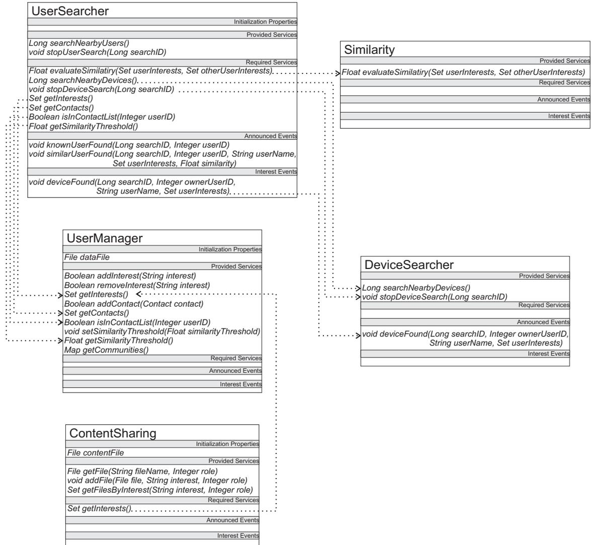
Figura 4.2: Especificação de componentes para Comunidades Virtuais Móveis
