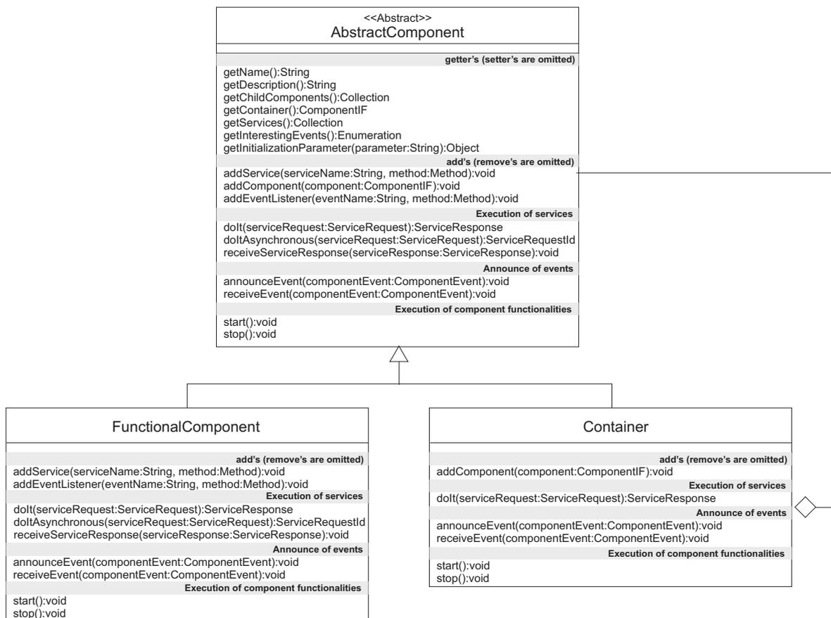
Figura 3.4: Diagrama das classes principais do arcabouço de software JCF
