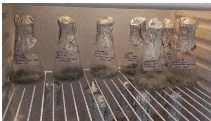
Figura 12. Fermentação semissólida do bagaço do sorgo sacarino utilizando Trichoderma reesei LCB 48
