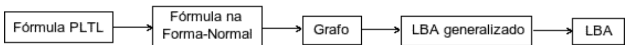
Figura 2.4: Visão semântica do algoritmo de transformação de fórmulas LTL para autômatos de Büchi.
