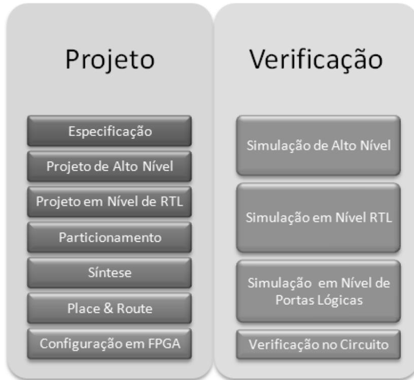
**Figura 1-1: fluxo de projeto baseado em FPGAs**
