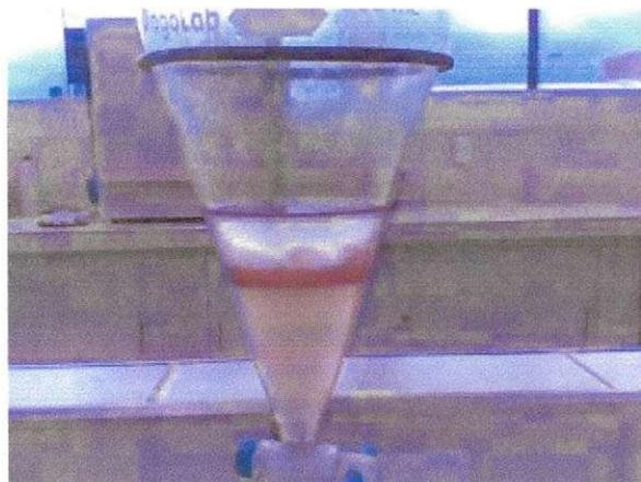
Figura 26: Região de Winsor II, microemulsão (acima) e fase aquosa (abaixo), a qual a microemulsão rica em  $\text{Fe}^{3+}$  foi depositada na MCM-41.
