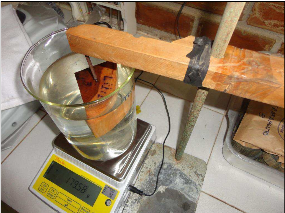
APÊNDICE 4 – Determinação do volume saturado (método da balança hidrostática)
