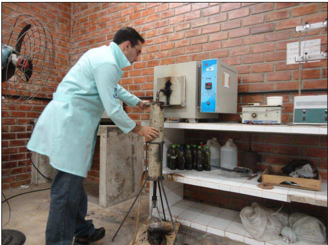
APÊNDICE 12 – Carbonização da madeira e coleta do líquido pirolenhoso
