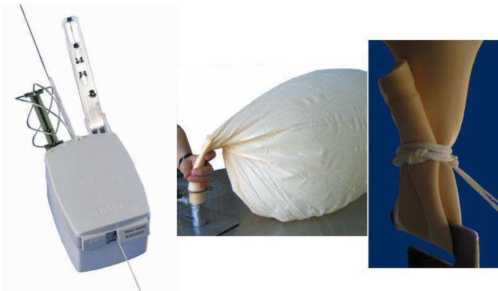
Figura 4 - Radiossonda Vaisala Digicora III<sup>®</sup> - Radiosonde (RS 92), com detalhes para o momento de enchimento e acoplamento ao balão de lançamento.
