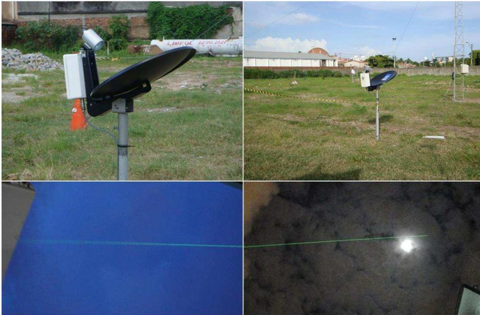
Figura 6 - Micro radar de apontamento vertical Keplel, 24.1 Ghz, instalado na sede da Defesa Civil de Fortaleza e em funcionamento durante o dia e durante a noite.
