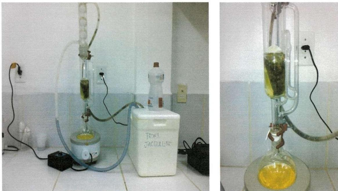
**Figura 10 - Aparelho de soxhlet.**
