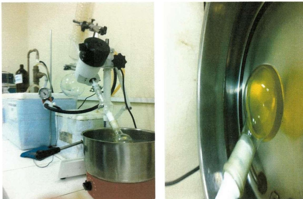
**Figura 11 - Evaporador rotativo.**
