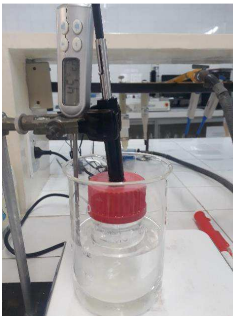
Figura 13 - Extração de voláteis de leite caprino por SPME-M Fonte: Acervo fotográfico pessoal (2020).
