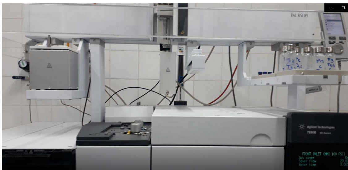
Figura 12 – Extração de voláteis de leite caprino por SPME-A
