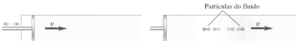
Figura 2.2: Onda Longitudinal se propagando em um tubo.
