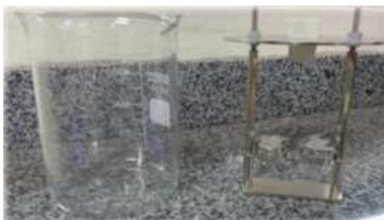
O ponto de amolecimento do asfalto foi determinado conforme a norma DNIT ME 131/2012. Neste teste a amostra é fundida e colocada em um molde que consiste de um anel de latão. O anel contendo a amostra é mantido suspenso em um banho de água destilada, a temperatura controlada, e sobre ele é colocada
