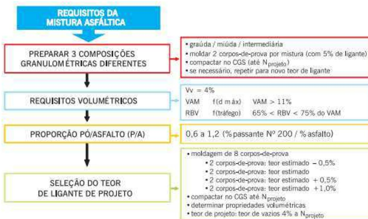
A escolha do teor ótimo de CAP foi obtida com os mesmos parâmetros descritos anteriormente no método Marshall, com exceção da estabilidade Marshall. Vale salientar que, no método de Dosagem Superpave, embora nenhum novo ensaio de agregados tenha sido desenvolvido, métodos atuais de seleção e especificação foram aperfeiçoados e incorporados ao método. Como exemplo, a utilização de pontos de controle, critérios de restrição de utilização de agregados, zona de restrição, entre outras.
