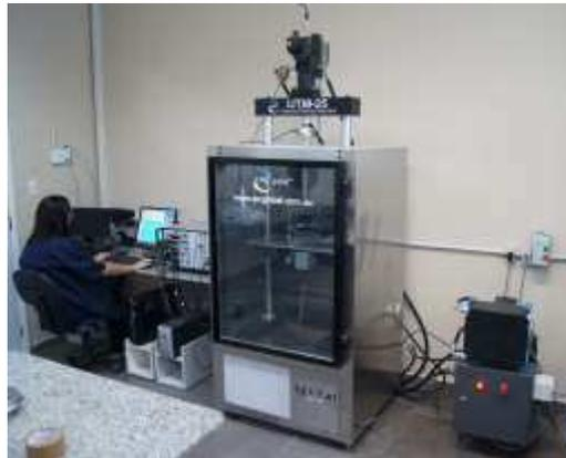
Esse equipamento é do tipo prensa servo-hidráulica UTM-25 (Universal Testing Machine) da IPC Global. O equipamento é composto de um sistema pneumático de carregamento, uma câmara para controle de temperatura, um sistema de medição de deformação da amostra, um software para aquisição e análise de dados e uma estrutura de suporte e alinhamento do corpo de prova (SANTOS, 2012).
