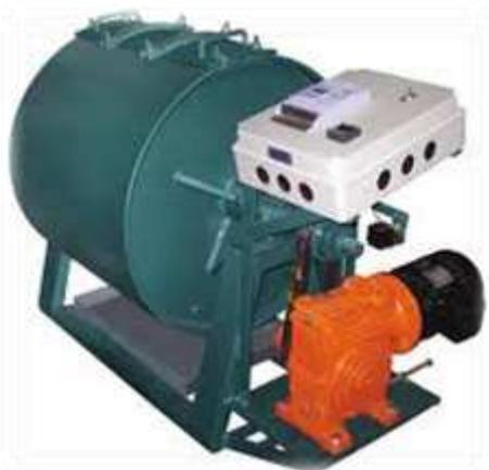
O ensaio de Abrasão é normatizado pela norma DNIT – ME 035/98. A normatização estabelece que para os serviços de pavimentação o valor da abrasão “Los Angeles” deve ser menor que 65%, portanto, o valor encontrado indica que o agregado pode ser utilizado em misturas asfálticas. Admitindo-se excepcionalmente agregados com valores maiores, no caso de terem apresentado comprovadamente desempenho satisfatório em utilização anterior.
