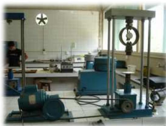
Figura 3.24 : Sequência do ensaio de resistência à tração por compressão diametral.
