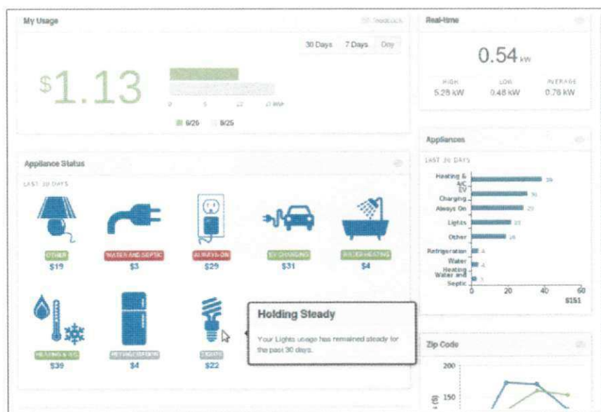
Figura A.4: Análises de consumo e identificação de eletrodomésticos pelo PlotWatt [31].
