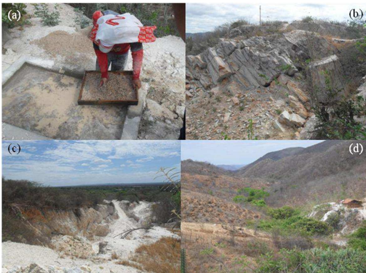
Figura 32: Atividade de mineração em São José da Batalha: (a) garimpeiro à procura de turmalina; (b) terreno erodido por consequência de queda de barreira em área de extração de turmalina; (c) cratera aberta para extração do caulim; (d) vista geral de parte do leito do Riacho Macambira, vendo-se à direita área de extração do caulim – vegetação esbranquiçada pela presença de particulados.
