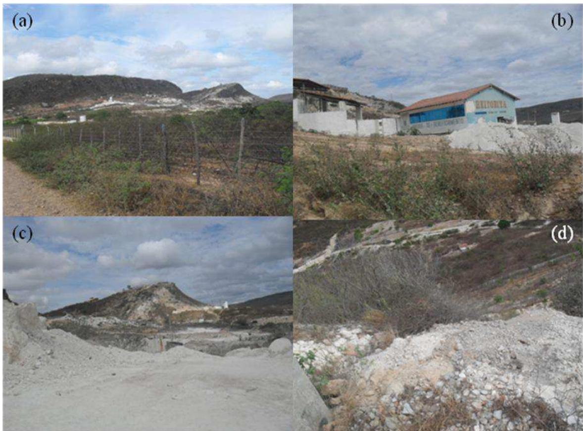
Figura 30: Mineradora em São José da Batalha: (a) vista parcial da área de mineração; (b) instalações da mineradora; (c) rejeitos de caulim; (d) rejeitos da mineradora sobre o solo e a vegetação.
