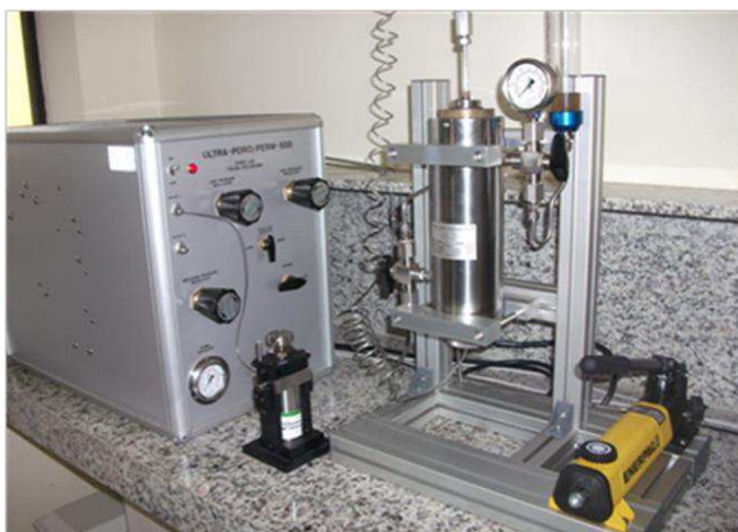
Figura 6: Equipamento UltraPoroPerm 500 ® utilizado na medição da porosidade e densidade de grãos. Fonte: (Soares et. al (2016)).
