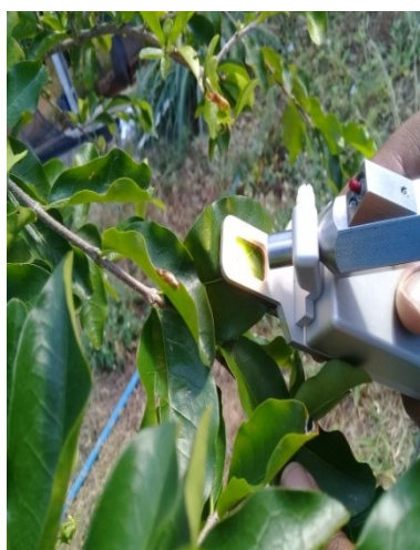
Figura 6. Análise da eficiência fotoquímica através da fluorescência da clorofila a com auxílio do equipamento PEA – Hansatech aos 540 DAT.
