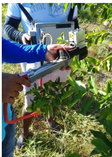
Figura 5. Avaliação das trocas gasosas nas plantas de aceroleira utilizando analisador de gás carbônico a infravermelho portátil (IRGA), modelo LCPro + Portable Photosynthesis System® (ADC BioScientific Limited, UK) aos 540 DAT.
