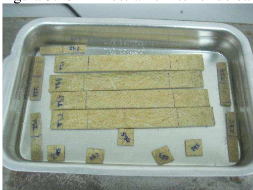
Figura 3.26 - Amostra no interior do banho térmico durante ensaio de sorção de água.
