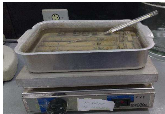
Figura 3.26 - Amostra no interior do banho térmico durante ensaio de sorção de água.
