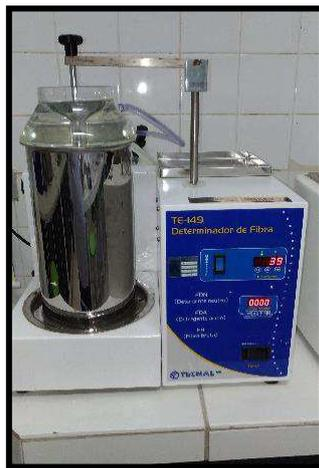
**Figura 3.4** -Determinador de fibra bruta pela digestão ácida e alcalina.
