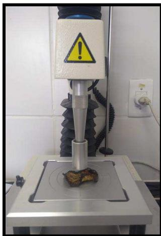
**Figura 3.5** - Texturômetro TA-Txplus Texture Analyser da Stable Micro System, utilizado para determinação da textura instrumental.
