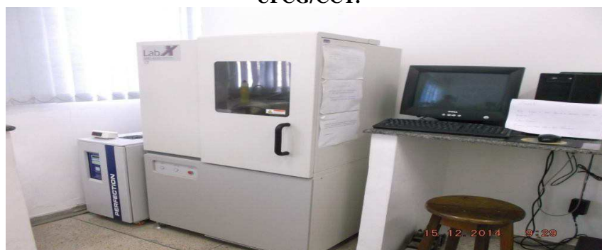
Figura 9: Figura 10: Difratômetro de raios-X localizado no laboratório de caracterização de materiais UFCG/CCT.
