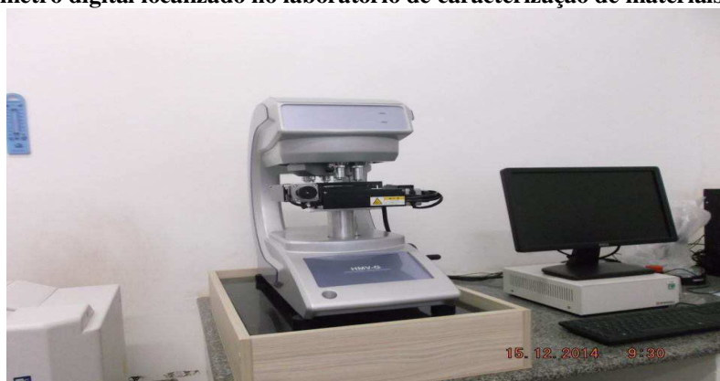
Figura 10: Microdurômetro digital localizado no laboratório de caracterização de materiais UFCG/CCT.
