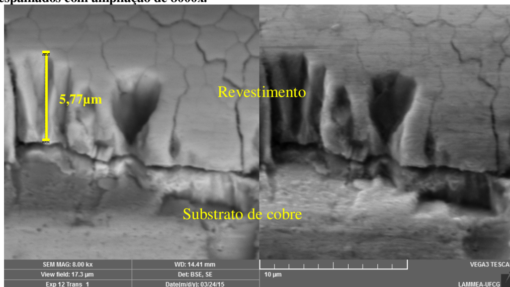
Figura 16:MEV da secção transversal do revestimento do experimento 12 obtidas com os elétrons secundários e retro espalhados com ampliação de 8000x.
