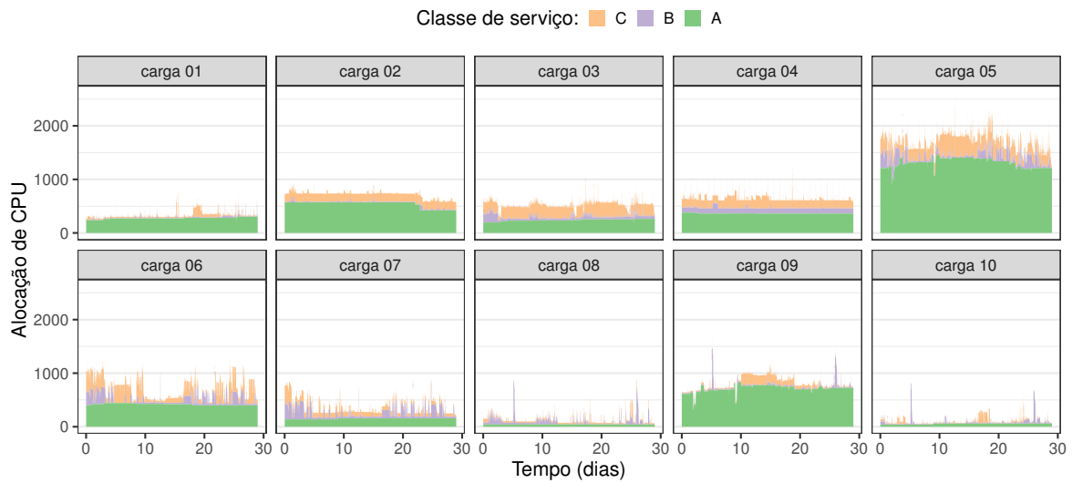
Figura 4.2: Alocação de CPU em intervalos de 1 minuto para as 10 amostras da carga de trabalho geradas.
