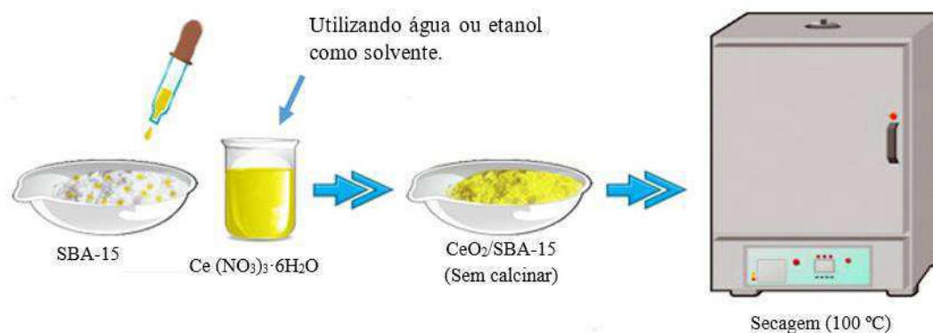
Figura 18 - Etapas do processo de impregnação por volume de poros dos suportes 10CeO 2 /SBA-15_VP H 2 O e 10CeO 2 /SBA-15_VP EtOH.
