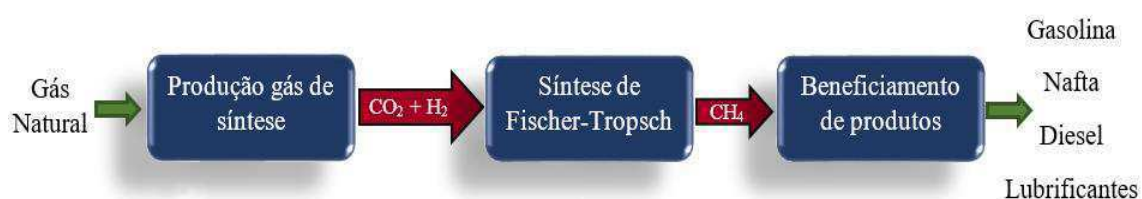
Figura 2 - Diagrama esquemático do processo GTL.
