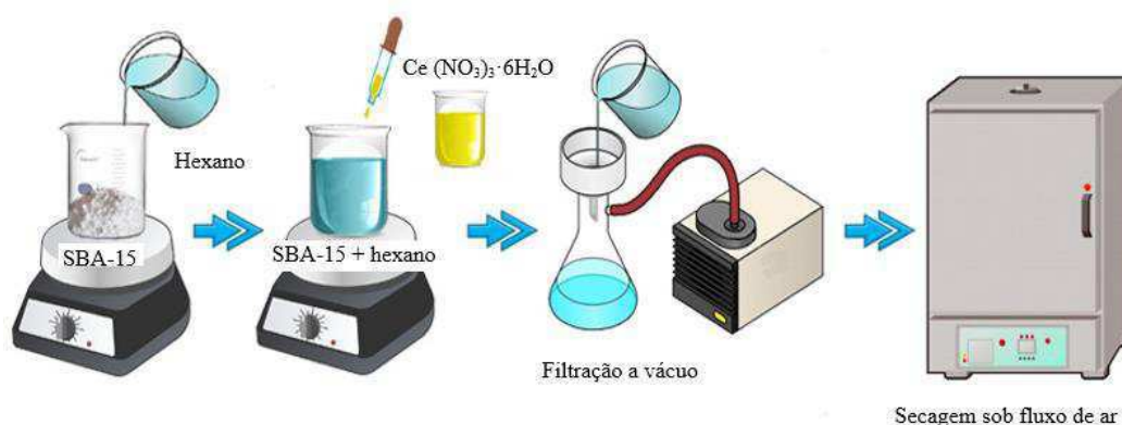
Figura 21 - Etapas do processo de impregnação pela técnica dos dois solventes do suporte 10CeO 2 /SBA-15_DS.
