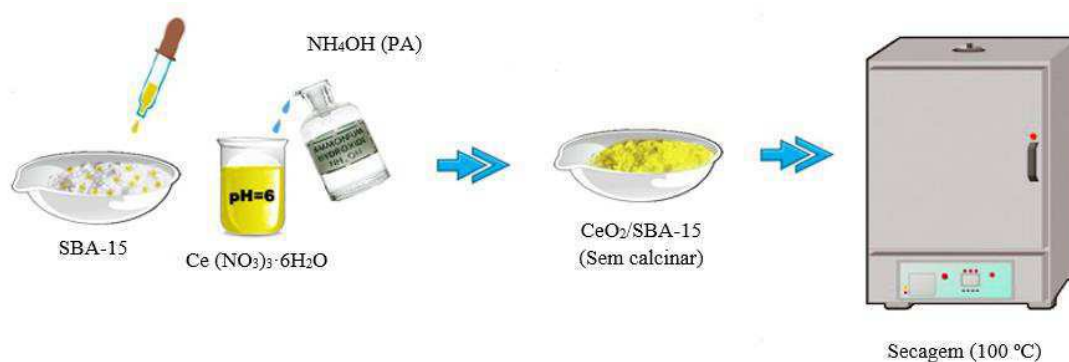
Figura 19 - Etapas do processo de impregnação por volume de poros com ajuste de pH do suporte 10CeO 2 /SBA-15_VPpH6.
