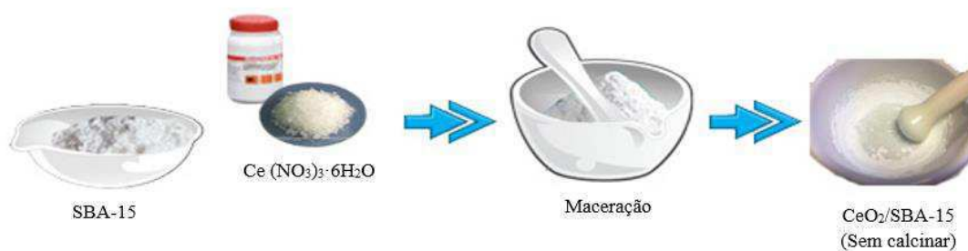
Figura 22 - Etapas do processo de impregnação por dispersão física do suporte 10CeO 2 /SBA-15_DF.
