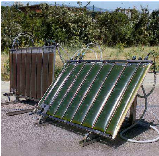
Figura 4. Modelo de fotobiorreator de placas planas para cultivo em massa de microalgas. Fonte: Fragoso, 2016.
