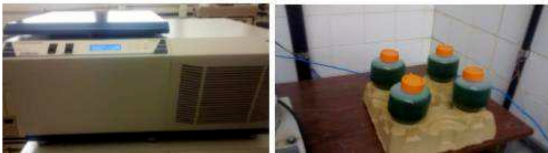
Figura 10. Processo de centrifugação da biomassa das microalgas cultivadas. Centrifuga refrigerada (Nova Técnica NT825); Tubos de 500 mL.
