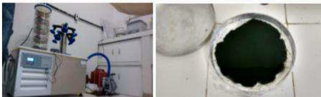
Figura 11. Processo de liofilização da biomassa das microalgas cultivadas. Liofilizador Terroni (modelo LD1500); Bandeja de alumínio com a biomassa concentrada.
