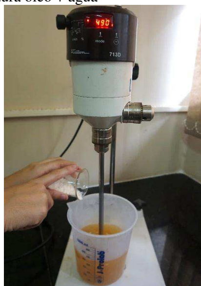
Figura 40 – Produção da emulsão: a) alginato de cálcio pesado em balança; b) alginato de cálcio sendo adicionado à mistura óleo + água
