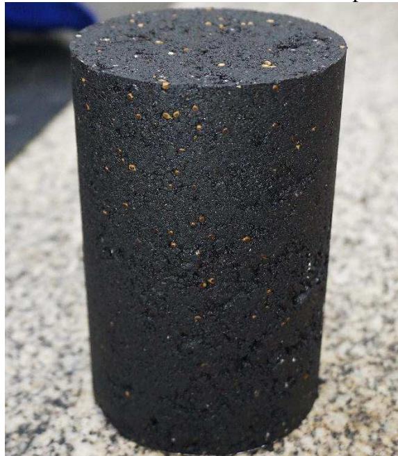
Figura 48 – Corpo de prova com 150mm de altura contendo cápsulas Tipo 1 residual
