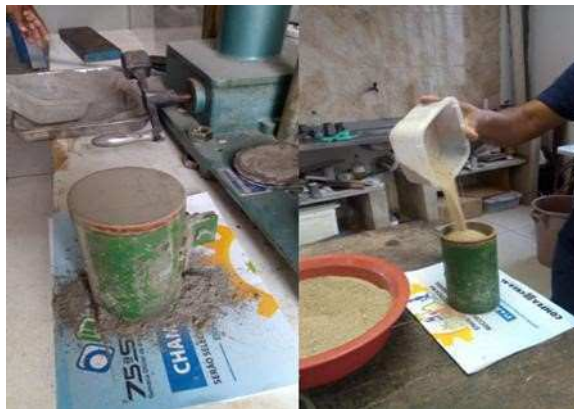
Figura 10. Ensaio de massa unitária, (a) resíduo de RO e (b) Areia natural
