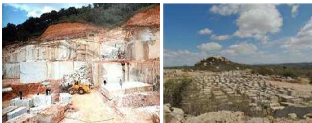
Figura 2. Processo de Extração dos blocos
