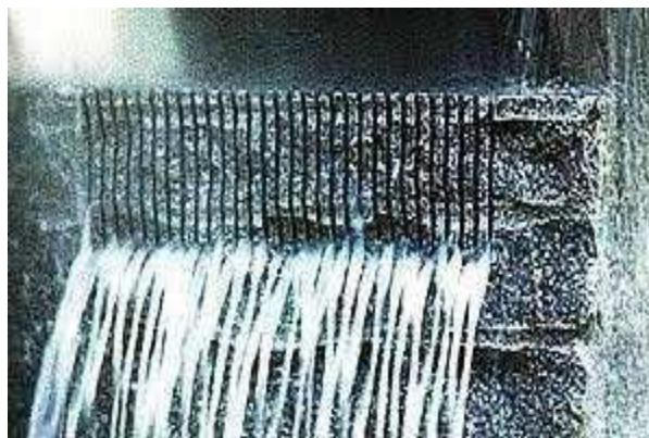
Figura 4. Desdobramento do bloco
