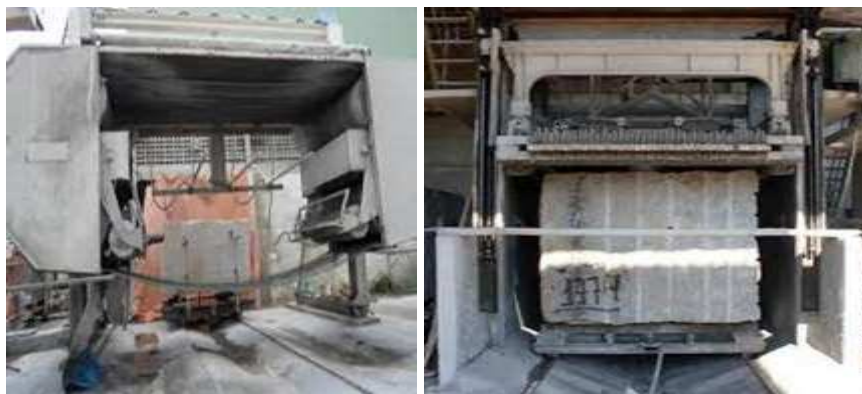
Figura 3. Tear, equipamento de corte dos blocos
