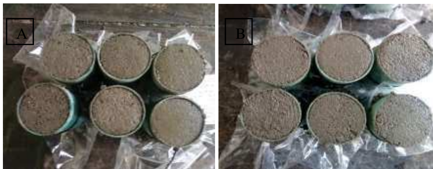
Figura 15. Argamassas confeccionadas para ensaio de atividade pozolânica
