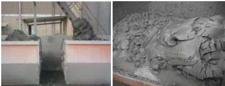
Figura 5. Reservatório de Resíduo de Rochas Ornamentais
