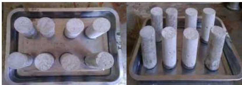
Figura 13. Ensaio de absorção de água por capilaridade
