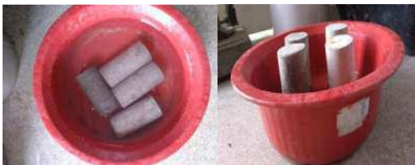
Figura 14. Ensaio de Absorção de água por imersão
