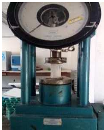
Figura 12. Equipamento para ensaio de resistência à compressão
