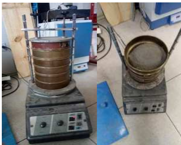
Figura 9. Ensaio de Granulometria dos Materiais
