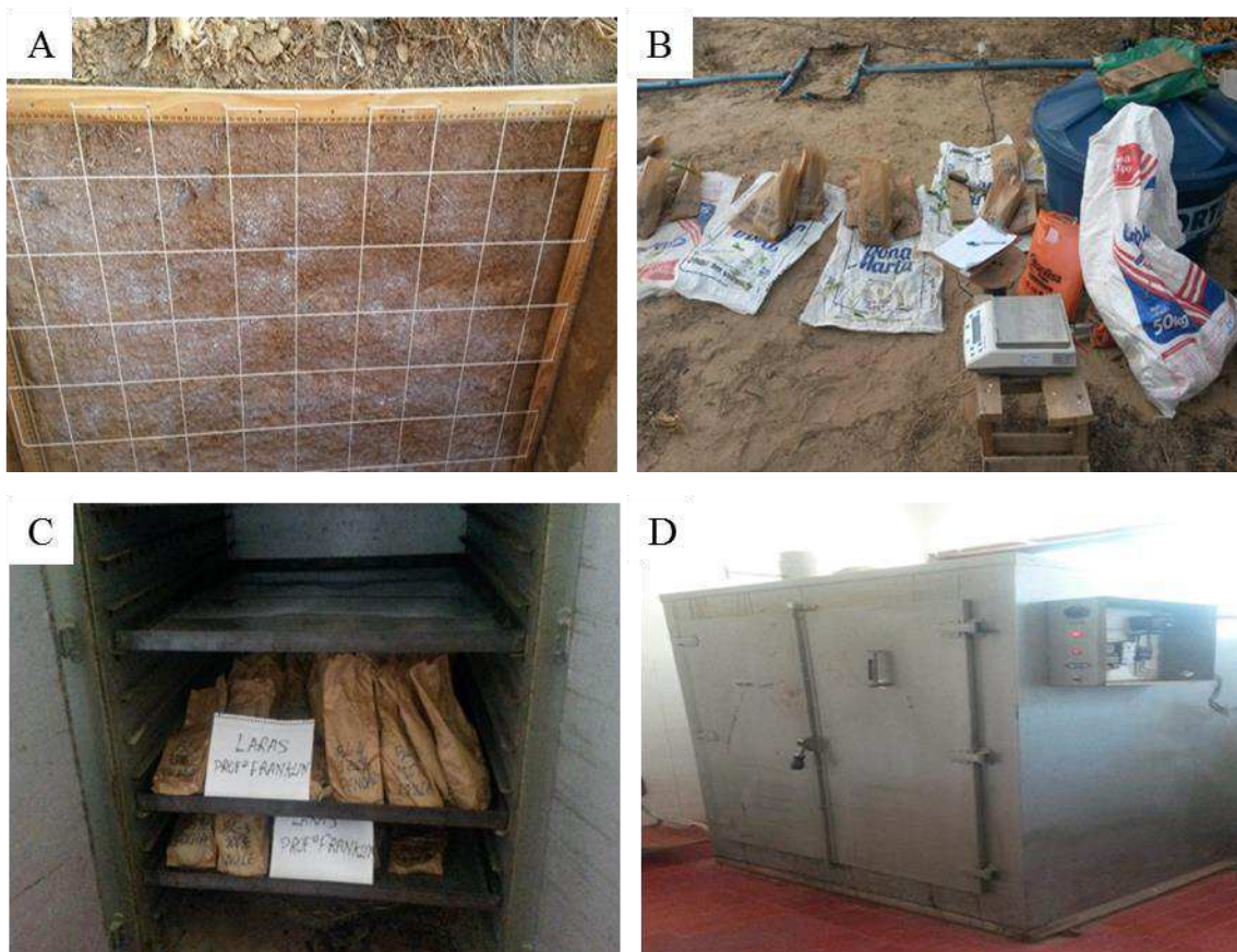
Figura 8. Trincheiras (1,0x1,0x1,30 m) na E2 durante a maturidade fisiológica (A), avaliação de massa seca pelo método destrutivo (B) na área experimental e secagem de massa seca (C) em estufa de ventilação forçada (D) no CECA-UFAL, Rio Largo, AL, 2015.
