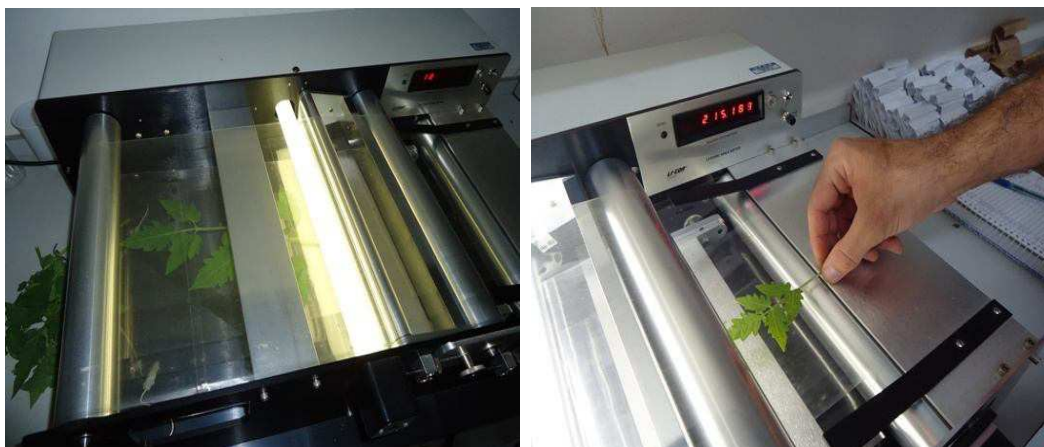
Figura 12: Realização da área foliar com o medidor de área foliar de bancada modelo LI-COR – LI-3100C
