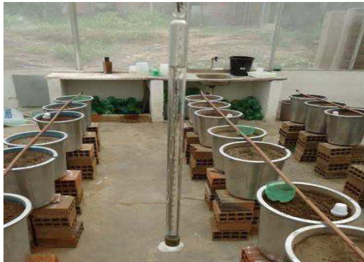
Figura 9: Evaporímetro de Piche instalado no interior da casa de vegetação
