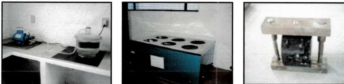
Figura 3.3 - Equipamentos utilizados para realização do ensaio de tração indireta [Bomba de vácuo - Banho maria - Pórtico de Lottman]
