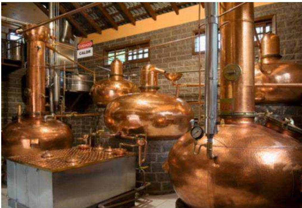
Figura 3 - Sistema de destilação em engenho de cachaça modernizante
