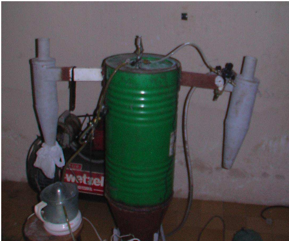
Figura 2.7 Equipamento de secagem das suspensões de Zinco-espíruína (MOREIRA, 2008).
