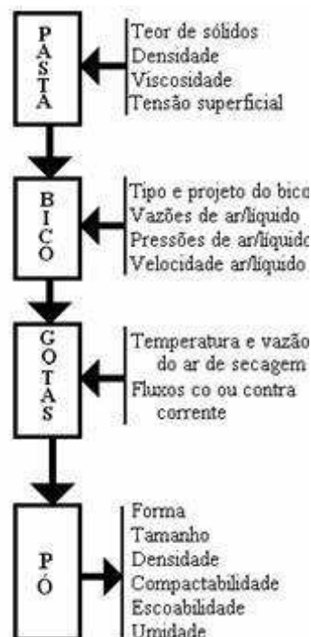
Figura 2.1 - Diagrama esquemático dos fatores que afetam secagem por atomização. (ROSA et al. , 2003).
