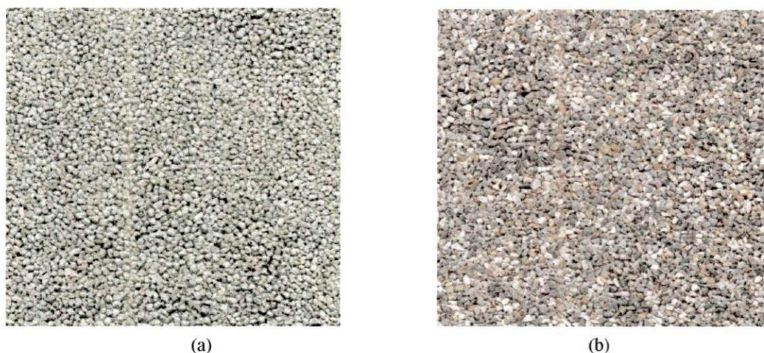
Figura 3.2 – Argilas (a) de Pernambuco e (b) Primavera após preparação (imagem das argilas em tamanho ampliado em 4 vezes)
