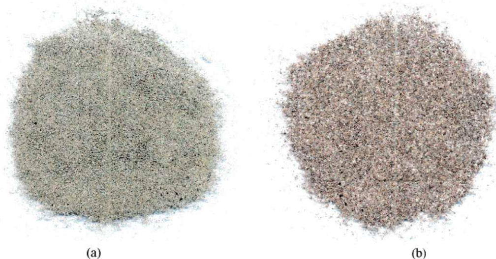
Figura 3.1 – Argilas (a) de Pernambuco e (b) Primavera após preparação (imagem das argilas em tamanho natural)
