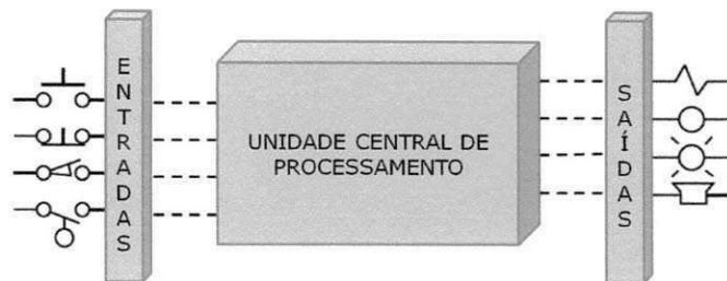
Figura 2.1: Esquema básico de um CLP (Fonte: Bryan & Bryan, 1997).
